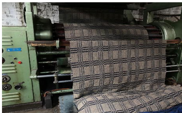
Figura 10. Proceso de afelpado, en afelpadora. Chiautempan, Tlaxcala. Imagen obtenida a partir del trabajo de campo. 2022.
