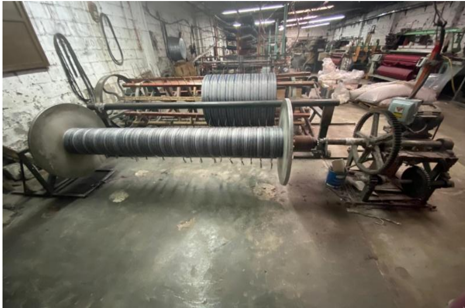
Figura 11. Proceso de hilado en urdidor, Chiautempan, Tlaxcala. Imagen obtenida a partir del trabajo de campo. 2022.
