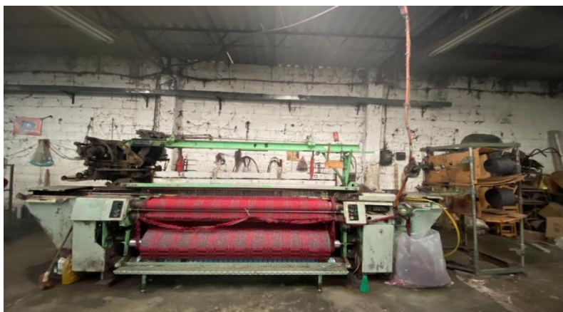
Figura 9. Proceso de tejido de cobertor príncipe, telar marca MACJ, Chiautempan, Tlaxcala. Imagen obtenida a partir del trabajo de campo. 2022.
