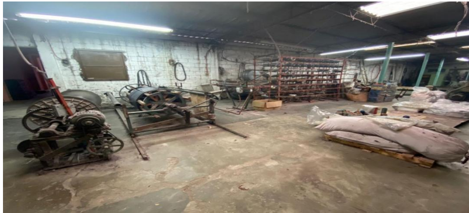
Figura 14. Urdidor con motor añadido y diseñado por obredores, Chiautempan, Tlaxcala. Imagen obtenida a partir del trabajo de campo. 2022.
